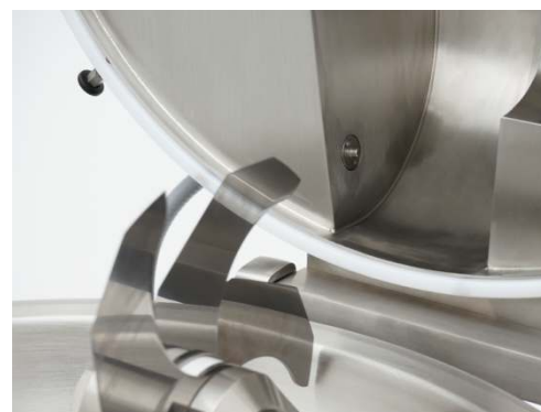
Bande de friction du couvercle/cuve démontable et auto-ajustable.
